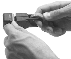
Конец кабеля вводится в паз устройства на отмеренную глубину.
