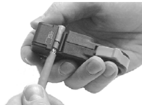
Удаляется оболочка кабеля и отрезанная часть экранированной оплетки.
