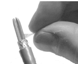
Удаляется защитная пленка жил кабеля.
