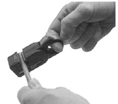
Выполняется 4 вращательных движения по направлению стрелки на корпусе устройства.
